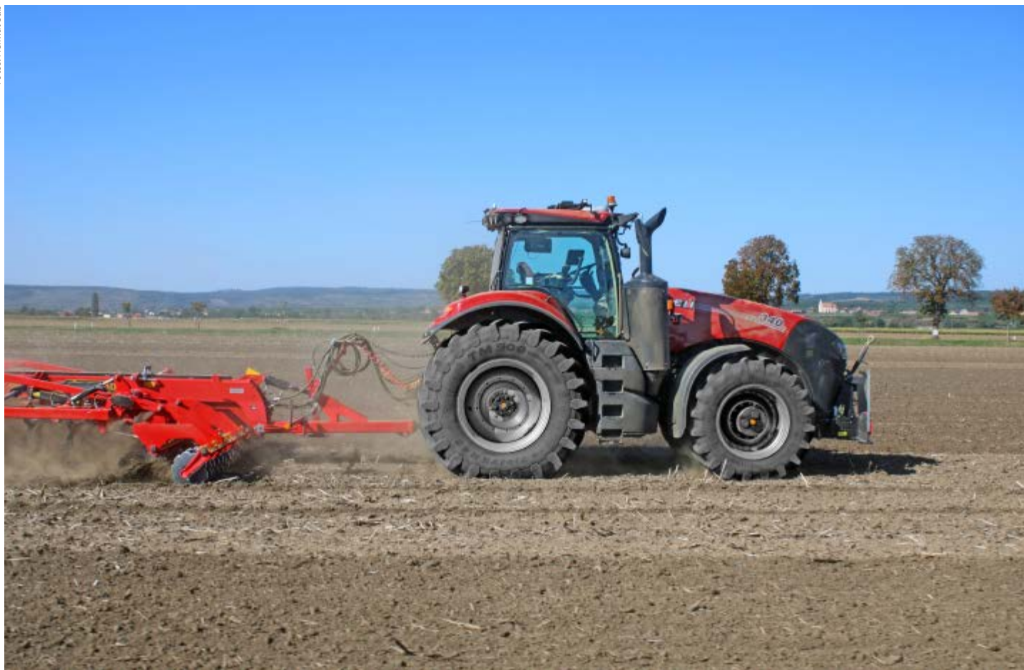
Wenn man genau hinschaut, sieht man, dass dieser Traktor ohne Fahrer, also autonom seinen Bahnen übers Feld zieht.
